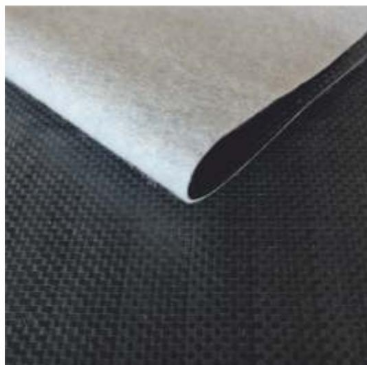
**Геосинтетик усиленный**, новый в линейке ЗАО «Втор-Ком» продукт. Полотно изготавливается путем соединения двух или более синтетических материалов, например, тканого геосинтетического полотна, нетканого геотекстиля, геомембранны и пр. Потребность в таком продукте возникает тогда, когда необходимо решить сложную, нестандартную задачу в дорожном строительстве, при прокладке трубопровода или возведении других объектов.
