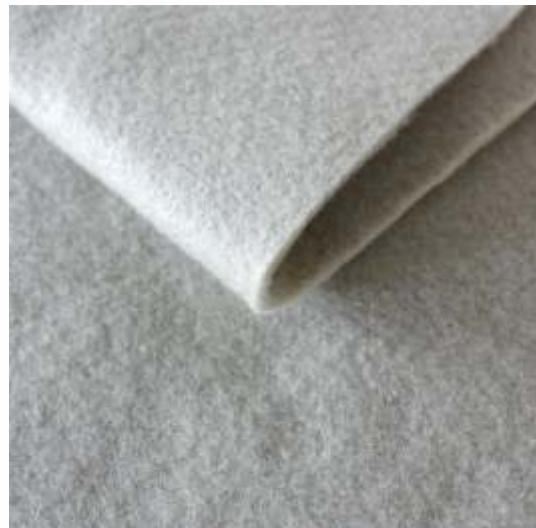
**Геотекстиль ВК (дорнит)** - это плоский водопроницаемый нетканый материал, полученный путем скрепления волокнистого холста из штапельных синтетических волокон иглопробиванием.
