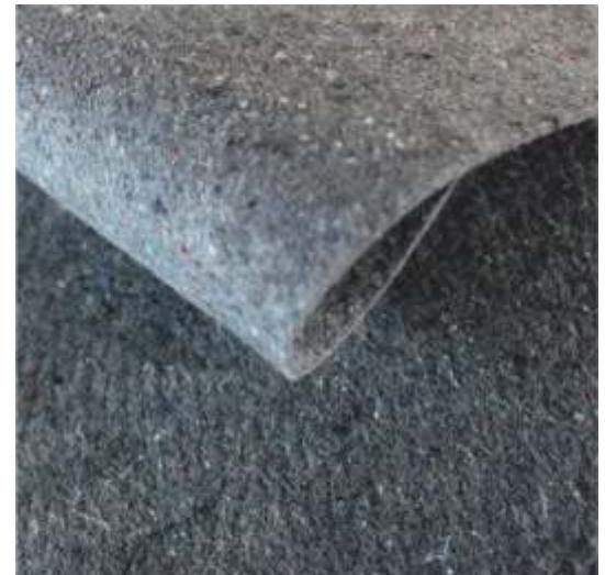
Термовойлок используется в качестве защитного слоя механизмов трансформации и деревянных рам в мягкой мебели, предохраняет мягкий слой матрасов от изнашивания, увеличивает ортопедические свойства готовой продукции. Также материал широко применяют при звукоизоляции.
